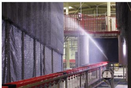
Se realizaron extensas pruebas de la boquilla T5 usando cálculos de espacio
